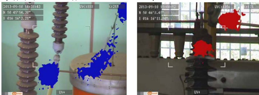
Рис. 3.4. Коронные разряды в лабораторных условиях.
