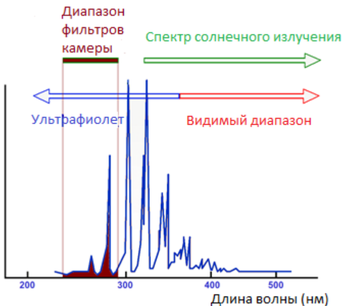
Рис 2. Спектр коронного разряда
