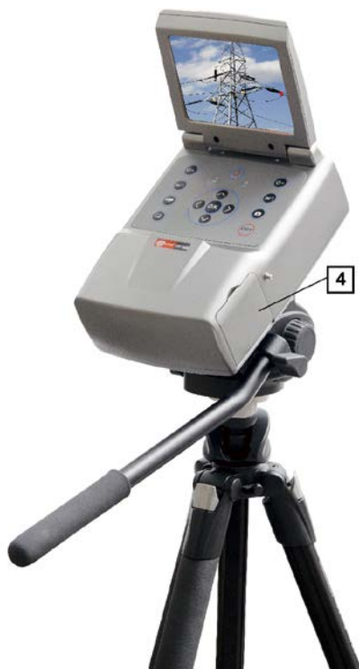
Рис. 12 Крепление UV-260 на штативе.
