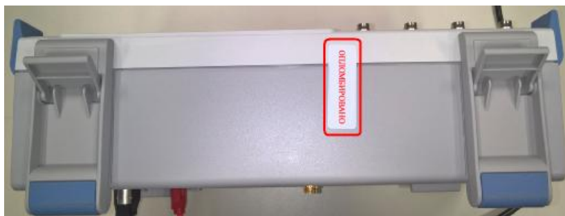
Рисунок 4 - Место пломбирования (вид снизу)
