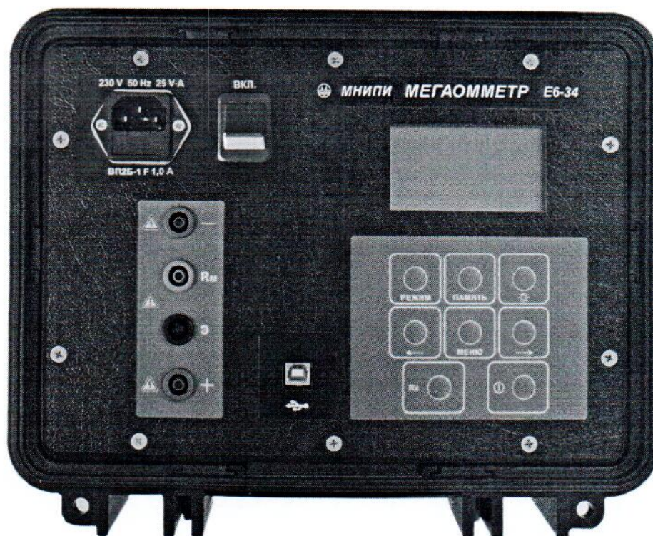
Рисунок 3 – Мегаомметр E6-34. Внешний вид передней панели
