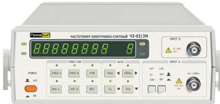
Частотомер электронно-счетный ПрофКиП ЧЗ-63 предназначен для измерения частоты и периода синусоидальных сигналов, частоты и периода повторения импульсных сигналов, длительности импульсов, отношения частот электрических сигналов, счета числа (суммирования) электрических колебаний. Частотомер электронно-счетный ПрофКиП ЧЗ-63 применяется для настройки, испытаний и калибровки различных приемопередающих трактов, фильтров, генераторов, синтезаторов частоты, систем связи и других устройств.
