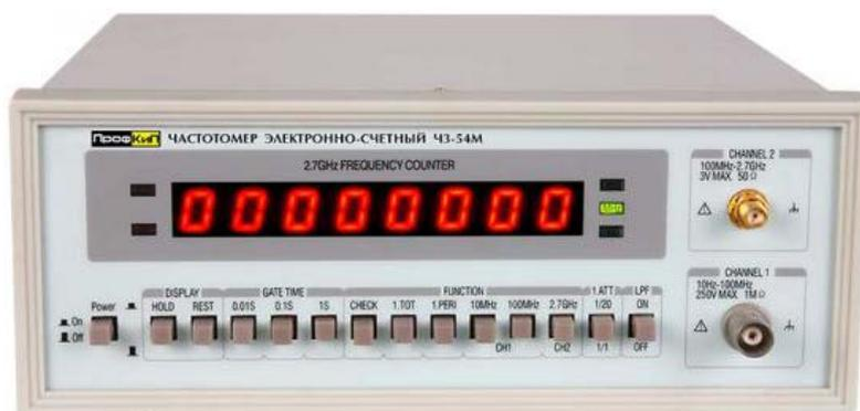
Частотомер электронно-счетный ПрофКиП ЧЗ-54М измеряет частоту в диапазоне от 10 Гц до 2700 МГц и период повторения сигналов. Его высокая точность, чувствительность и универсальность делают его исключительно ценным инструментом для ученых, инженеров и специалистов в области связи.
