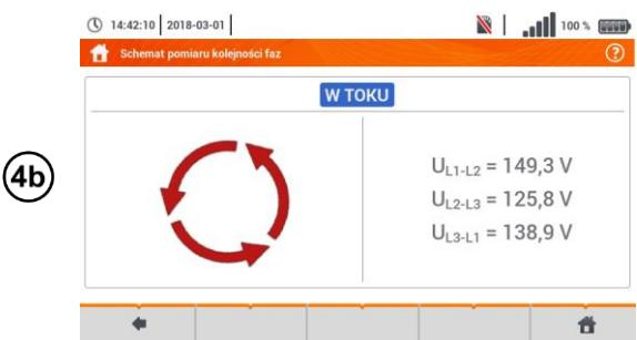
Последовательность фаз **обратная**, т.е. порядок чередования фаз **против** движения часовой стрелки.
