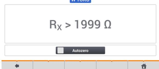
Чтобы компенсировать сопротивление измерительных проводов, выберите **Автообнуление**.
