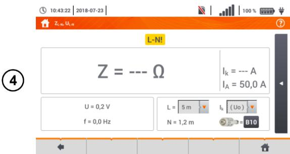
Результат измерения можно сравнить с критерием допустимого сопротивления петли короткого замыкания  $Z_{sdop}$ , определённого на основе параметров защиты измеряемой цепи:
