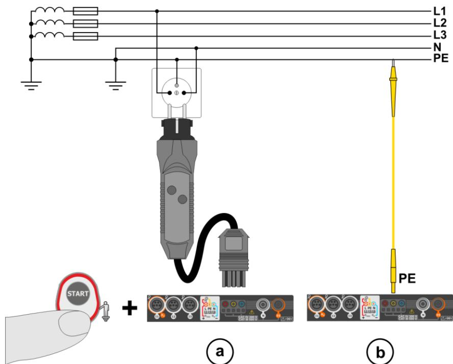
После подключения измерителя, как на рисунке, прикоснитесь к сенсорному электроду и подождите примерно 1 сек. Если на проводе PE будет обнаружен потенциал, то:
