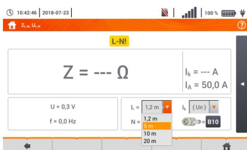
Достоверность измерений зависит от ввода правильной длины измерительных проводов.
