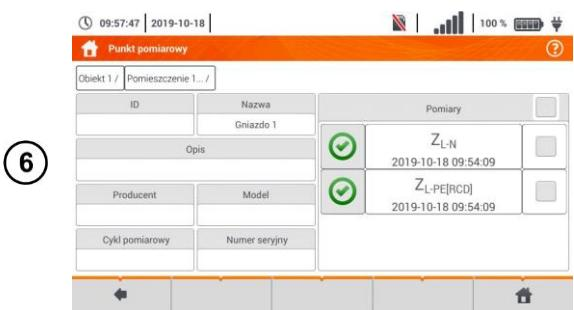
Все результаты измерения последовательности будут сохранены в одной точке измерения.
