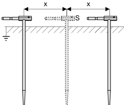
Повторить шаги 2 5 6 для двух дополнительных положений электрода напряжения S:
