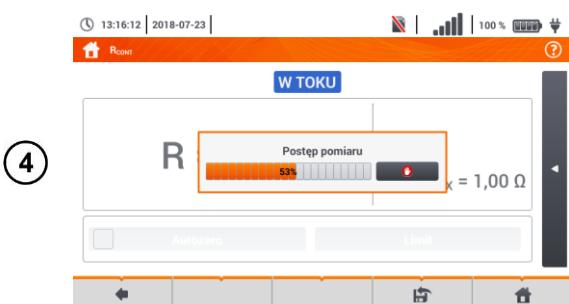
Чтобы **выключить компенсацию** сопротивления проводов, необходимо повторить шаги ②③ с **разомкнутыми** измерительными проводами. Тогда результат измерения будет **включать в себя также сопротивление измерительных проводов**.
