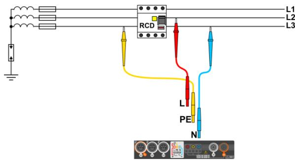
Рис. 4.2 Тестирование УЗО без участия провода РЕ
