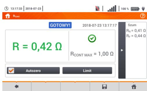
Результат является средним арифметическим от значения двух измерений при токе 200 мА противоположных полярностей  $R_F$  и  $R_R$ .
