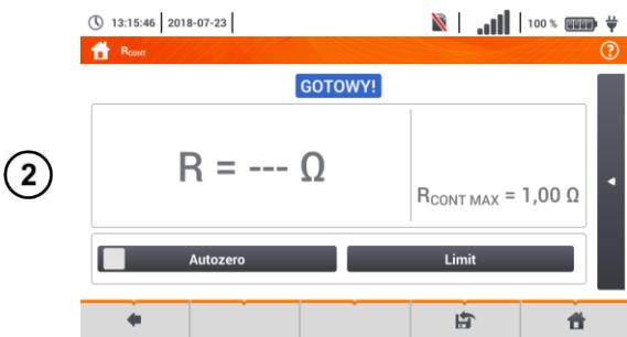
Для устранения влияния сопротивления измерительных проводов на результат измерения, можно выполнить его компенсацию (Автообнуление). С этой целью выберите **Автообнуление**.
