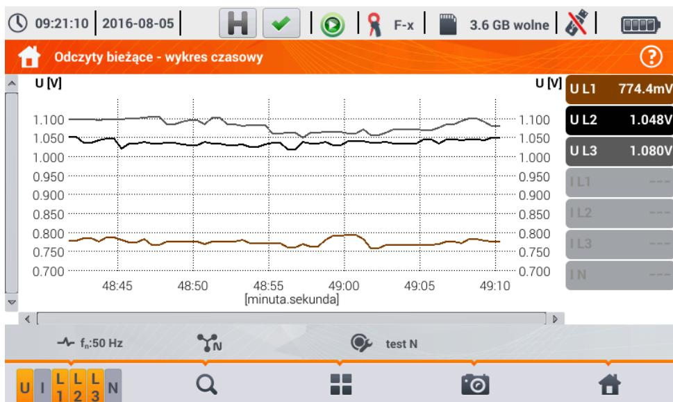
Рис. 6.14. Текущие показания – временной график
