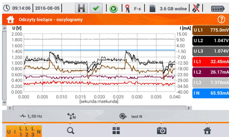
Рис. 6.13. Текущие показания – осциллографмы
