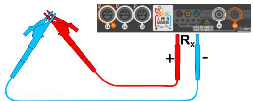
Чтобы **выключить компенсацию** сопротивления проводов, необходимо повторить шаги ②③④ с **разомкнутыми** измерительными проводами. Тогда результат измерения будет **включать в себя также сопротивление измерительных проводов**.
