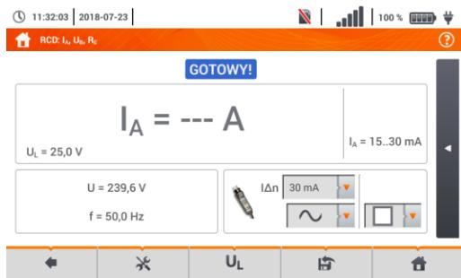
Выбрать  $U_L$ , чтобы установить напряжение измерения.
