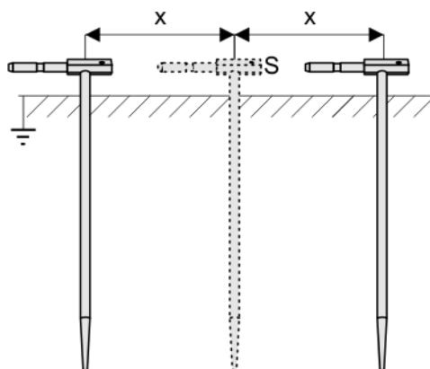
Повторить шаги ②⑤⑥ для двух дополнительных положений электрода напряжения **S**:
