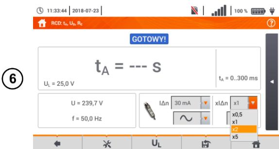
6 Если в шаге ① выбран режим RCD  $t_A$ , задайте ток срабатывания тестируемого УЗО.
