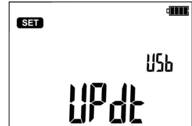
Клавишами и перейти к следующему экрану обновления программного обеспечения измерителя: **UPdt**.
