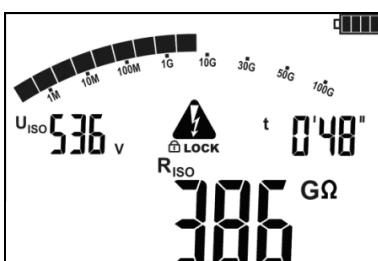
Вид экрана во время измерения. **LOCK** означает, что идёт автоматическое измерение т.е. запущенное с помощью клавиши **ВВОД** или при нажатии и удерживании клавиши **СТАРТ** в течение приблизительно 5 секунд.
