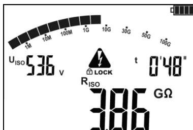
Вид экрана во время измерения. означает, что идёт автоматическое измерение т.е. запущенное с помощью клавиши **ВВОД** или при нажатии и удерживании клавиши **СТАРТ** в течение приблизительно 5 секунд.
