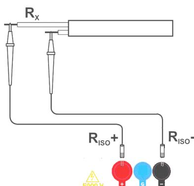
Подключите измерительные провода согласно рисунку.
