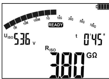
После окончания или прерывания измерения, на дисплее можно считать результат. Отображаются результаты всех измерений, которые были проведены (также в случае прерывания измерения, например, по истечении 60сек.). Если прибор переключился в состояние готовности, то результат измерения можно восстановить на экран клавишей **ВВОД**.
