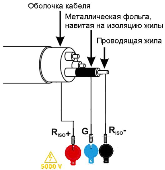
Таким же способом подключается разъём **G** при измерении сопротивления между двумя жилами к третьей, не участвующей в процессе измерения.
