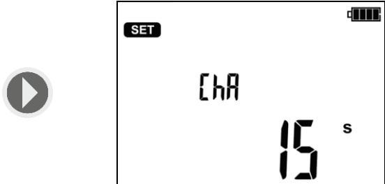
Следующее нажатие ➡ вызывает переход к установке интервала времени ChA для снятия характеристики  $R_{iso}$ .
