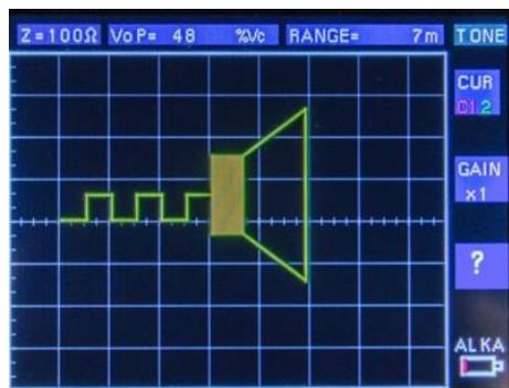
Рефлектометр TDR-420 также может использоваться как генератор звукового сигнала при идентификации кабельных пар и жил кабелей. Для приема этого сигнала можно применить индукционные датчики, используемые, например, в телекоммуникации и работающие в диапазоне 810...1110 Гц. После выбора этого режима, в жилы кабеля, к которым подключены провода рефлектометра, передается модулированный звуковой сигнал, служащий для идентификации.
