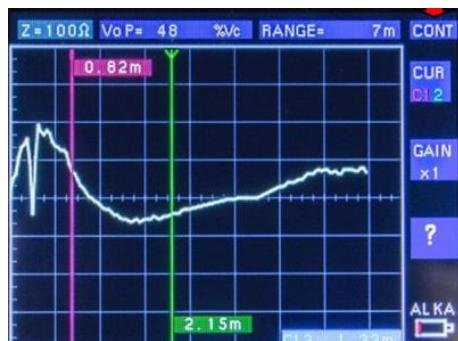
После нажатия клавиши **START** рефлектометр непрерывно отправляет и получает зондирующие импульсы в тестируемую пару проводов (кабеля), что позволяет идентифицировать кратковременные нарушения. Пользователь самостоятельно рассматривает сигнал кабеля, наблюдая результат сканирования на различных диапазонах измерения, и сам устанавливает курсор (курсоры) в наблюдаемое место повреждения кабеля, чтобы получить показание расстояния до этой точки (**глава Ошибка! Источник ссылки не найден.**).
