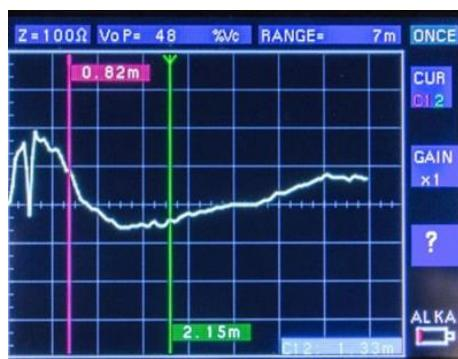
После нажатия клавиши **START** будет послан один зондирующий импульс. Пользователь самостоятельно рассматривает сигнал рефлектометра в кабеле, наблюдая результат сканирования на различных диапазонах измерения. Он сам устанавливает курсор (курсоры) в наблюдаемое место повреждения кабеля, чтобы получить показание расстояния до этой точки (**глава Ошибка! Источник ссылки не найден.**).
