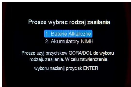
Клавишами  $\Delta$  и  $\nabla$  выбрать примененный источник питания и нажать **ENTER**. Это необходимо для **правильной индикации состояния заряда элементов питания**, так как напряжение и характеристики разряда батареек и аккумуляторов различные.
