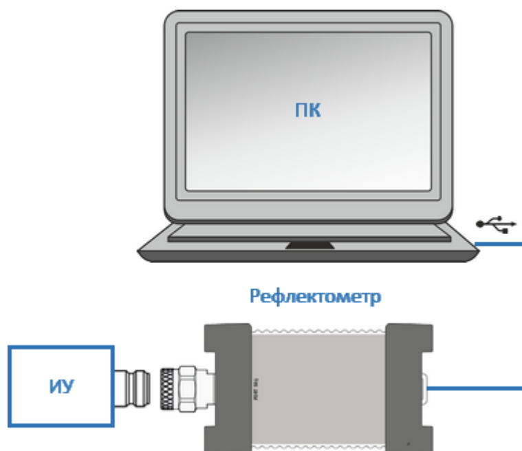
Рисунок 32 – Схема измерения коэффициента отражения ИУ
