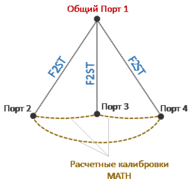
Рисунок 104 – Пример упрощенной полной двухпортовой калибровки с нормализацией модуля коэффициента передачи для 4 портов
