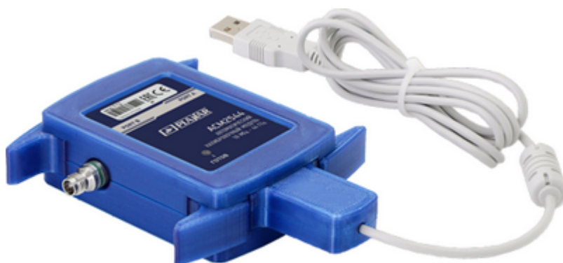
Рисунок 105 – Автоматический калибровочный модуль
