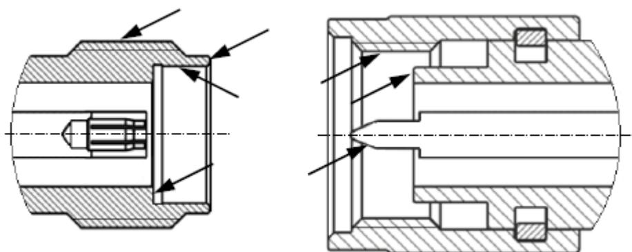
Рисунок 12 – Соединители тип 3,5 мм (розетка слева, вилка справа)
