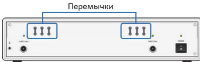
2. Присоедините к измерительным портам анализатора переходы коаксиальные, позволяющие прямое подключение исследуемого кабеля RF (LO).
