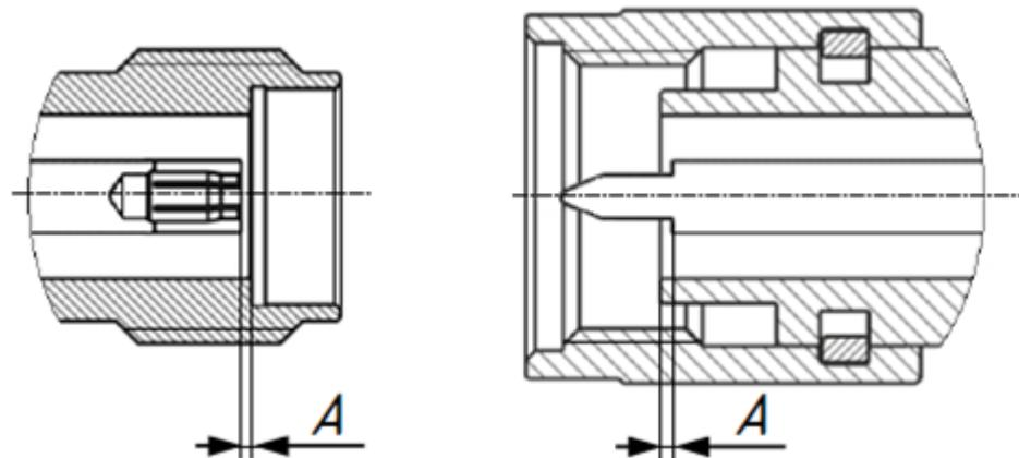
Рисунок 14 – Соединители тип 3,5 мм (розетка слева, вилка справа)
