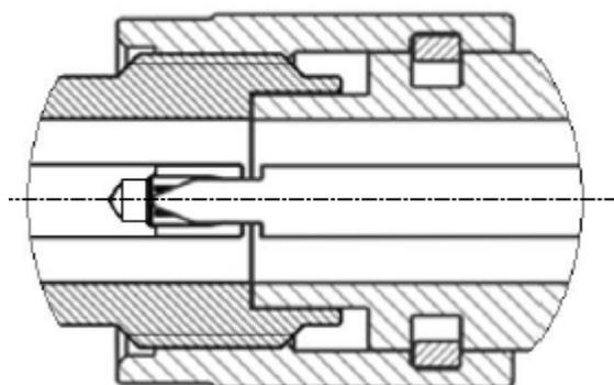
Рисунок 9 – Соединители тип 3,5 мм (розетка слева, вилка справа)
