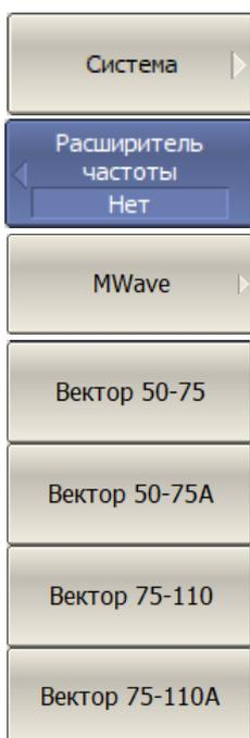
Для выбора модуля расширения частотного диапазона нажмите кнопки:
