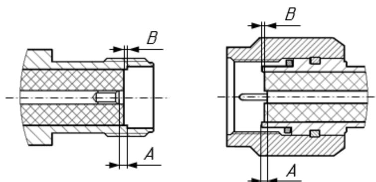
Рисунок 13 – Соединители тип SMA (розетка слева, вилка справа)
