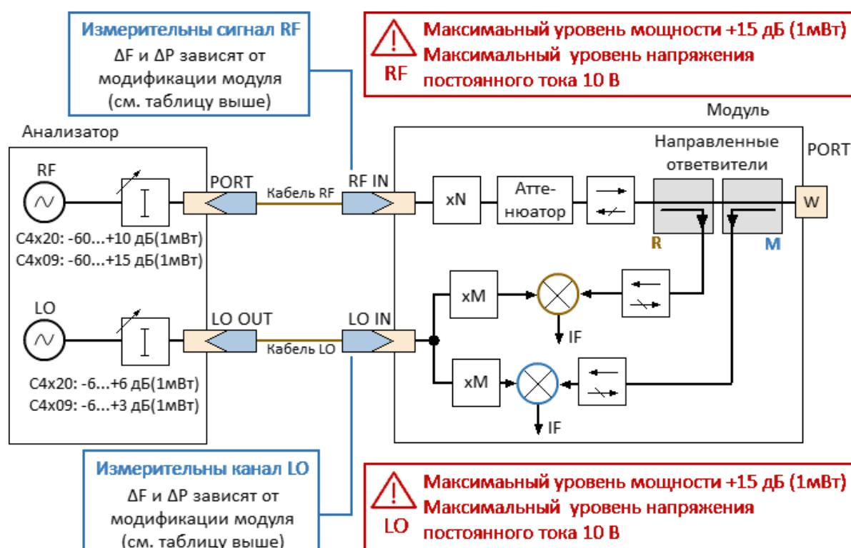
Рисунок 15 – Передача измерительного и гетеродинного сигналов между анализатором и модулем
