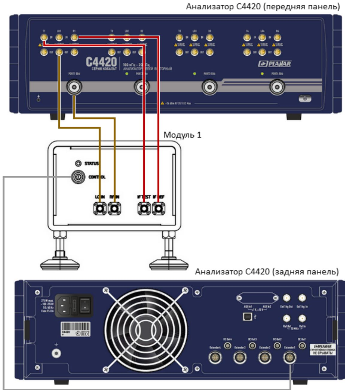
Рисунок 7 – Подключение к анализатору цепей векторному C4420
