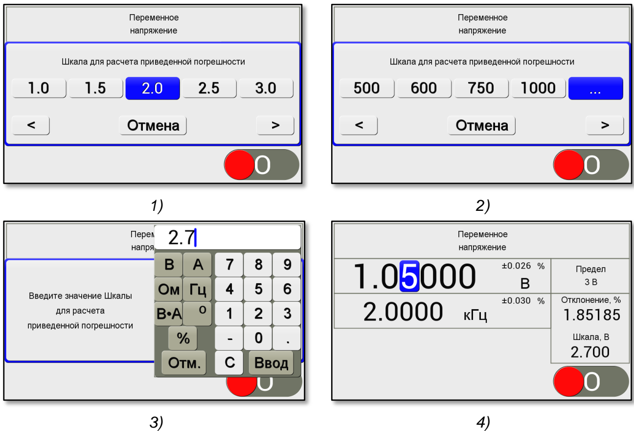
Рисунок 9.28 – Последовательность изображений индикатора при вводе значения шкалы
