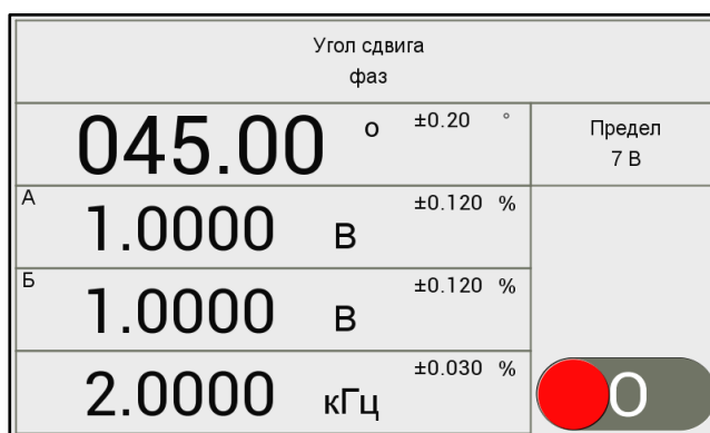
Рисунок 9.23 – Вид индикатора в режиме установки УФС между двумя синусоидальными сигналами с выхода двухканального генератора
