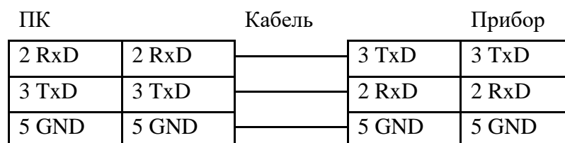
Рисунок 9.31 – Соединение по интерфейсу RS-232
