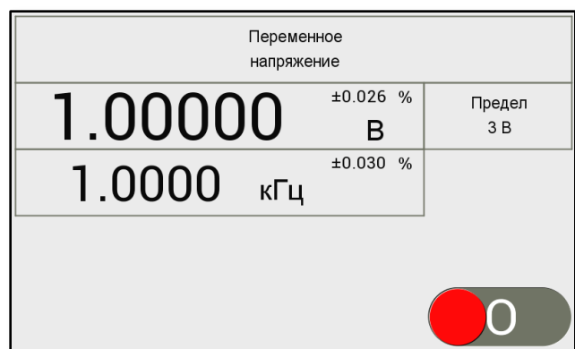
Рисунок 9.14 – Вид индикатора в режиме воспроизведения напряжения переменного тока
