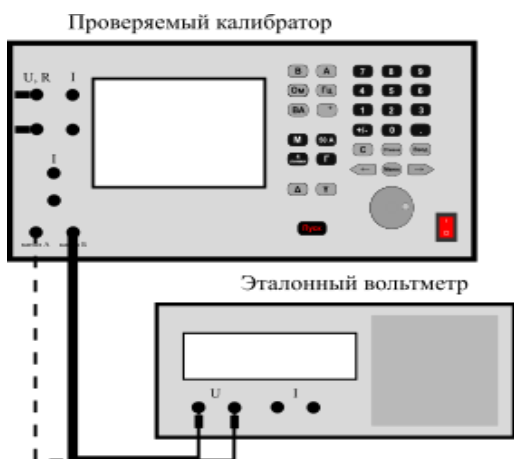
Рисунок 13.7 – Измерительная схема для определения погрешности воспроизведения напряжения переменного тока с выхода двухканального генератора
