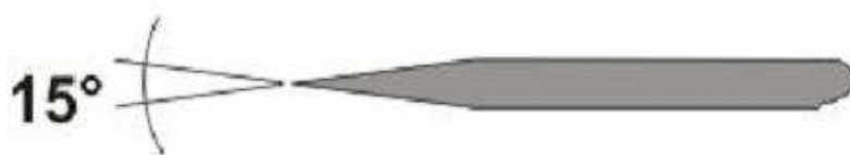
Рис. Форма заточки вольфрамового электрода
