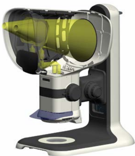
Независимые оптические пути для формирования стереоизображения в системе Dynascope
