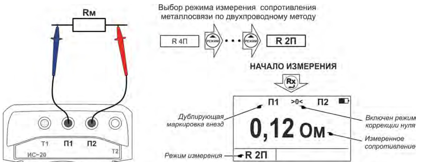
Рисунок 2.8 – Схема подключения и вид индикатора при двухпроводном методе измерения
