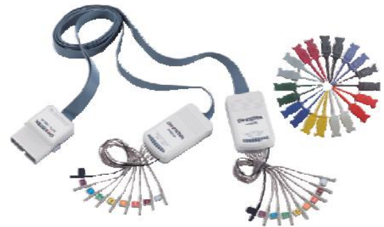
Внешний вид 16 кан лог. пробника (опция DS3A-16LA)
