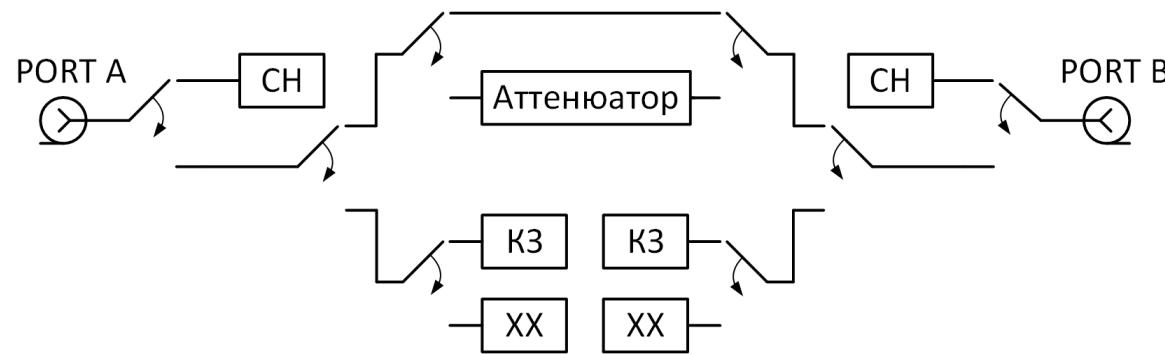
Рисунок 1 – Функциональная схема ACM6000T, ACMB2506 и ACM4000T
