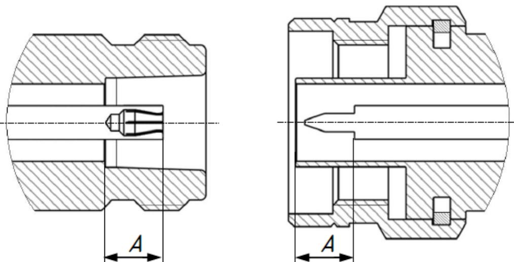
Рисунок 36 – Соединители типа N и III (розетка, вилка)
