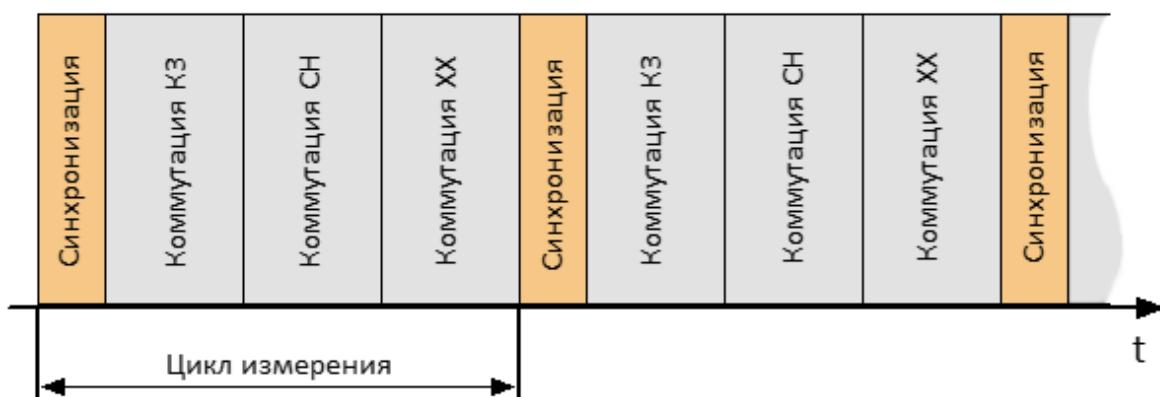
Рисунок 7 – Цикл измерения
