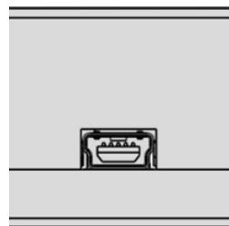
**Рисунок 24 – Соединитель mini USB**
