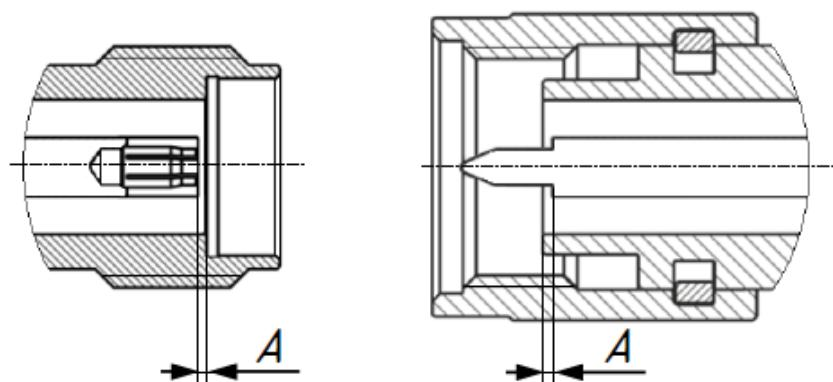
Рисунок 37 – Соединители 2,4 мм, 2,92 мм, 3,5 мм, IX (розетка, вилка)
