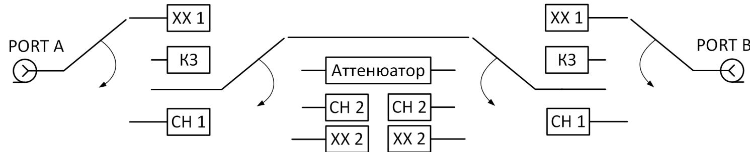
Рисунок 2 – Функциональная схема ACM2532, ACM2544, ACM8000T
