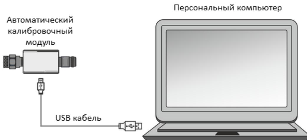
Рисунок 8 – Подключение модуля к ПК
