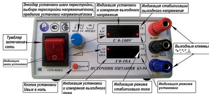
Рисунок 1.4 – Органы управления на передней панели источника питания.
