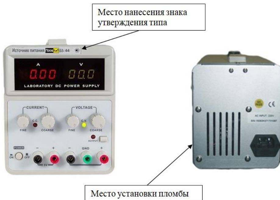
Рисунок 1 Общий вид источников питания ПрофКиП Б5-44, ПрофКиП Б5-45, ПрофКиП Б5-46/1, ПрофКиП Б5-70/1
