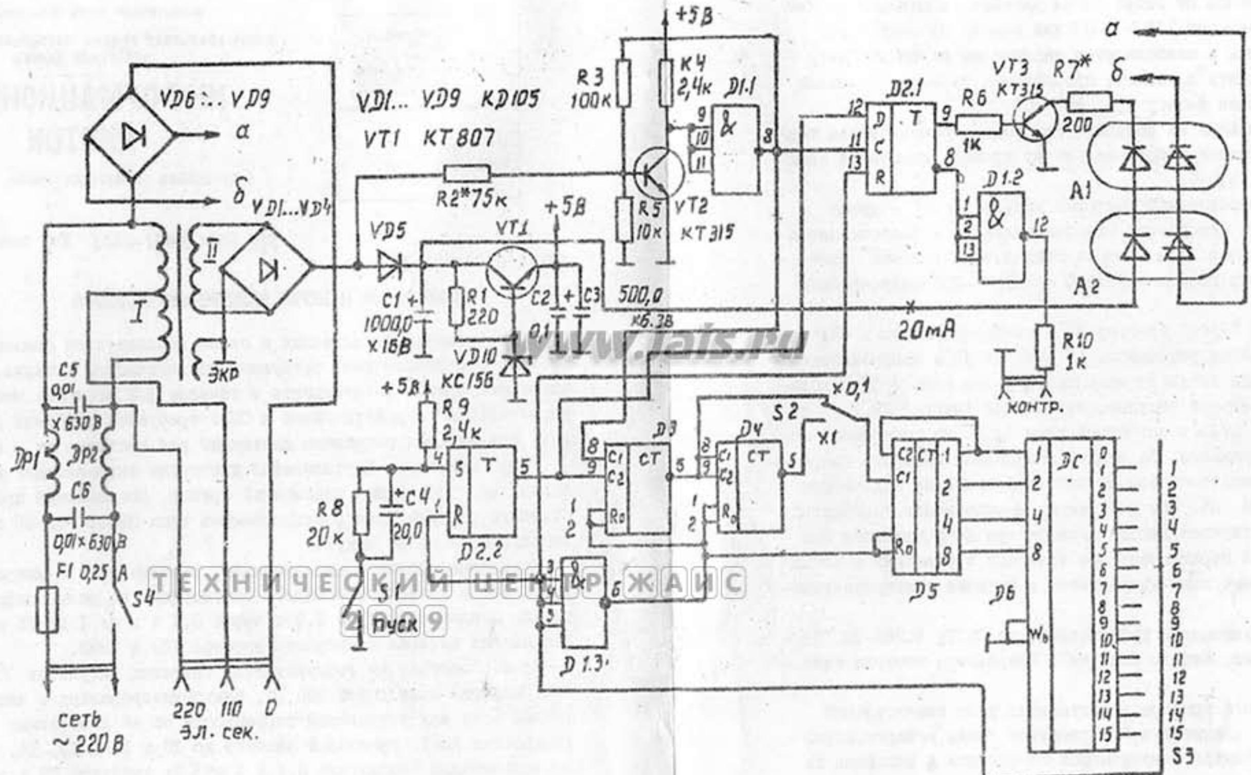
Рис. Схема прибора для поверки электросекундомеров ПС-3
