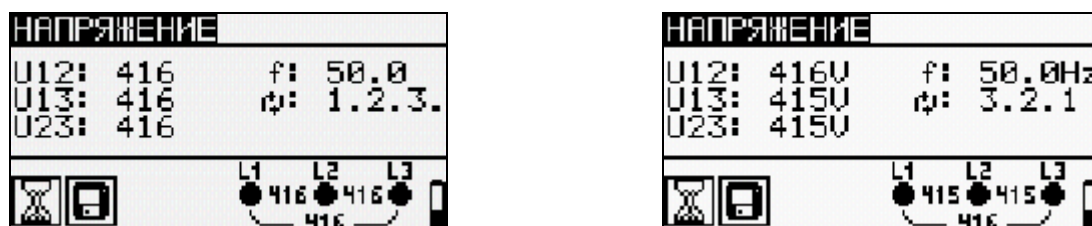
Рисунок 5.17: Примеры измерения напряжения в трехфазной цепи
