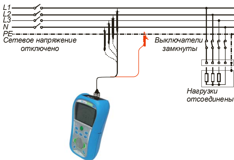
Рисунок 5.2: Подключение 2-проводного измерительного кабеля
