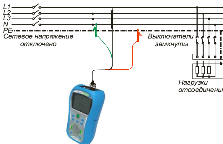
Рисунок 5.3: Подключение 3-проводного измерительного кабеля
