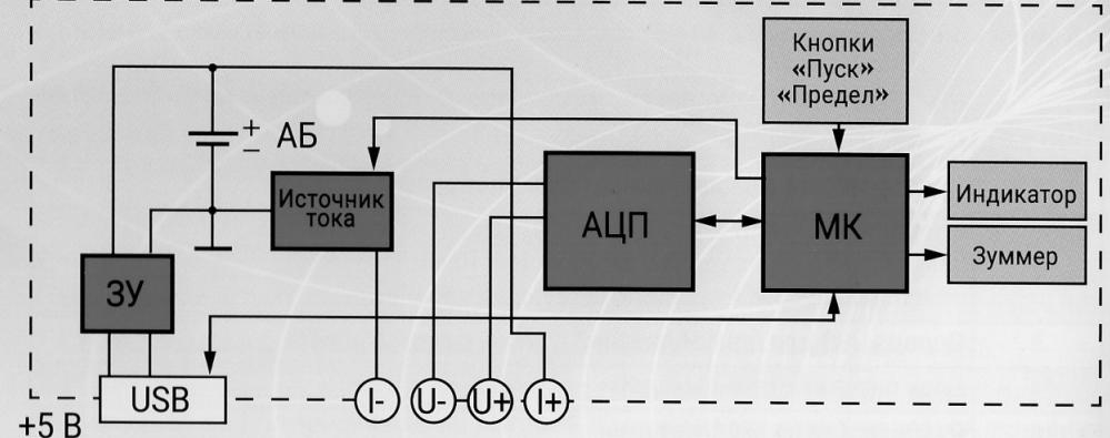
Рис. 1. Упрощенная блок-схема прибора ИКС-1А
