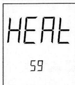
Сенсор нагревается до рабочей температуры. На индикаторе появится сообщение „HEAT“ (Нагрев) и в нижней части дисплея включается обратный отсчет от 60 до 0 секунд.
