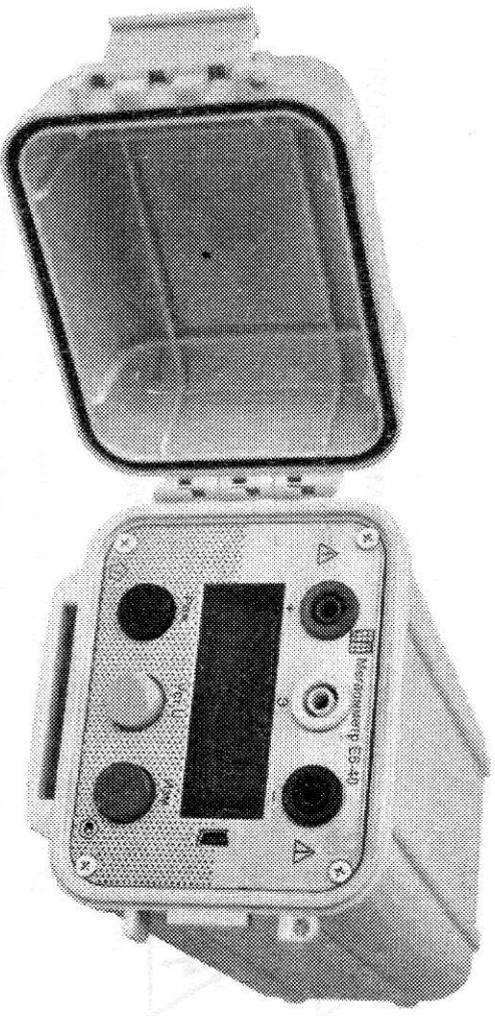
Рисунок 1 - Внешний вид мегаомметра.
