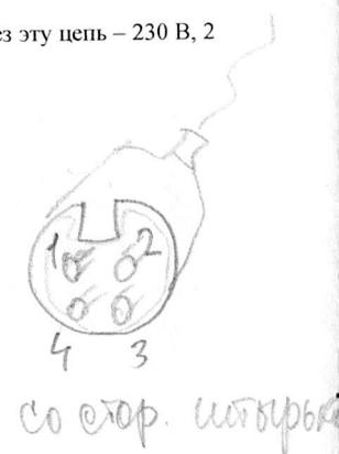
Рис. 2. Схема подключения цепей блокировки и внешней сигнальной лампы к установке.
