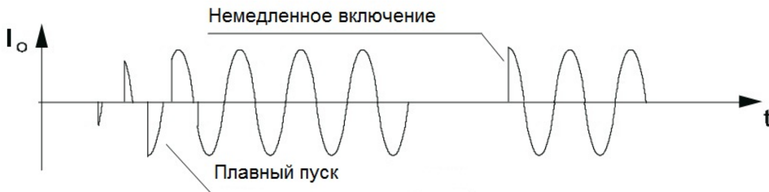
Рис.10. Управление пороговым регулятором, осциллограммы сигналов по отношению к нейтрали – резистивная нагрузка
