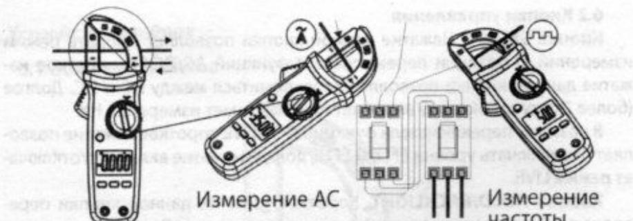
Рис. 2 Измерение силы и частоты переменного тока
