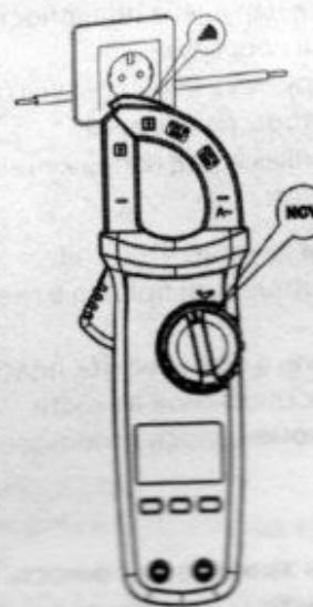
Рис. 5 Бесконтактное обнаружение переменного напряжения
