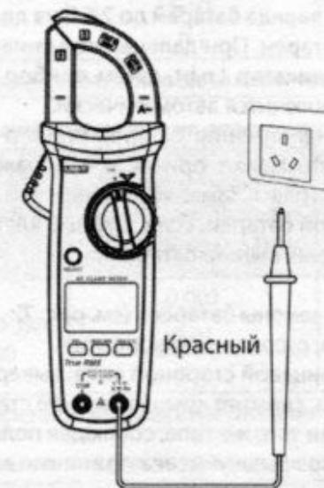
Рис. 6 Определение нуля и фазы
