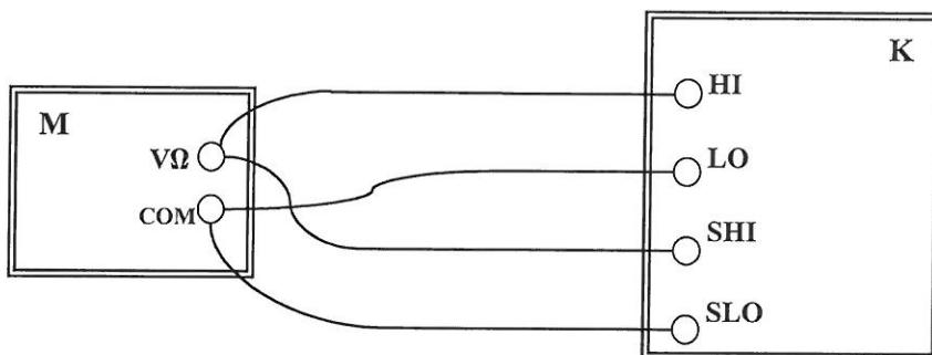
Рисунок 1. К – калибратор; М – поверяемый мультиметр
