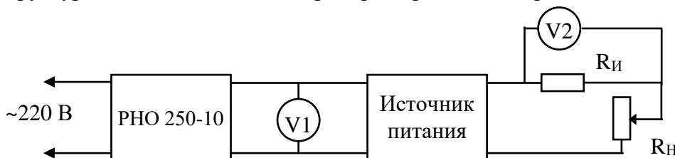
Рис. 2. Структурная схема определения основной погрешности измерения выходного тока
