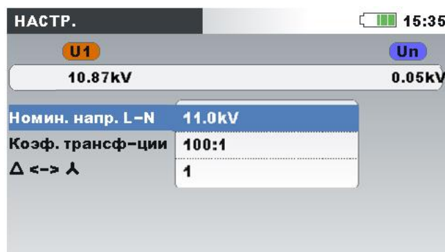
Рисунок 4.13: Коэффициент трансформации для трансформатора 11 кВ/110 кВ (пример)
