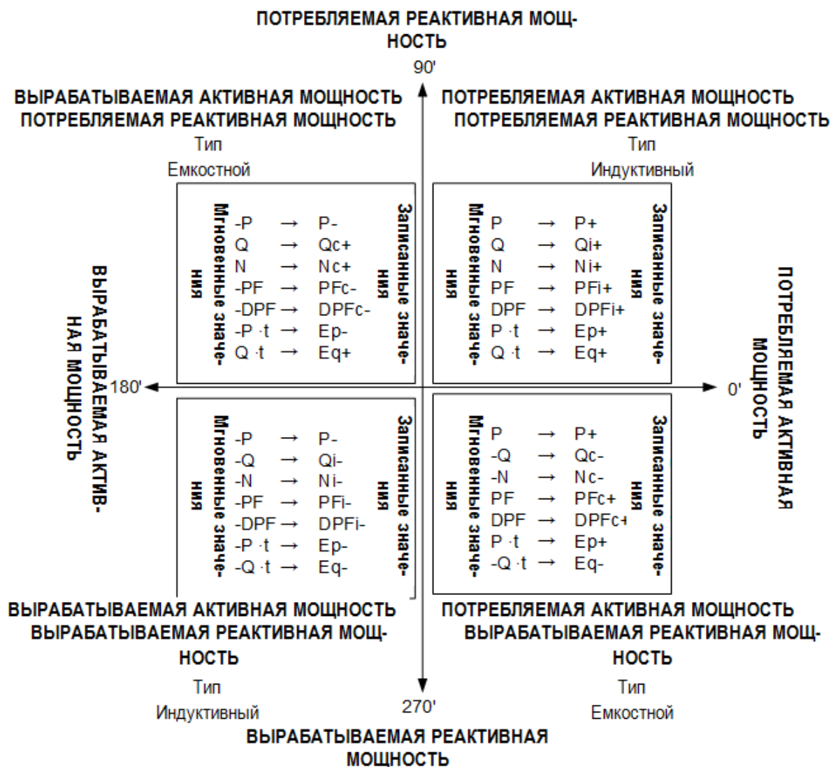
Рисунок 5.15: Фазовая диаграмма/диаграмма полярности потребляемой/генерируемой и индуктивной/емкостной мощности
