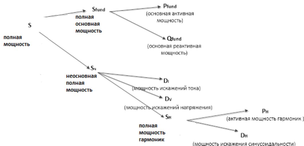
Рисунок 5.2: Организация измерения мощности фазы согласно стандарту IEEE 1459
