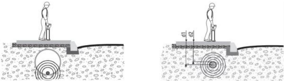
d1 – глубина, отображаемая на дисплее приемника LKO-1000, равна расстоянию до оси объекта.
