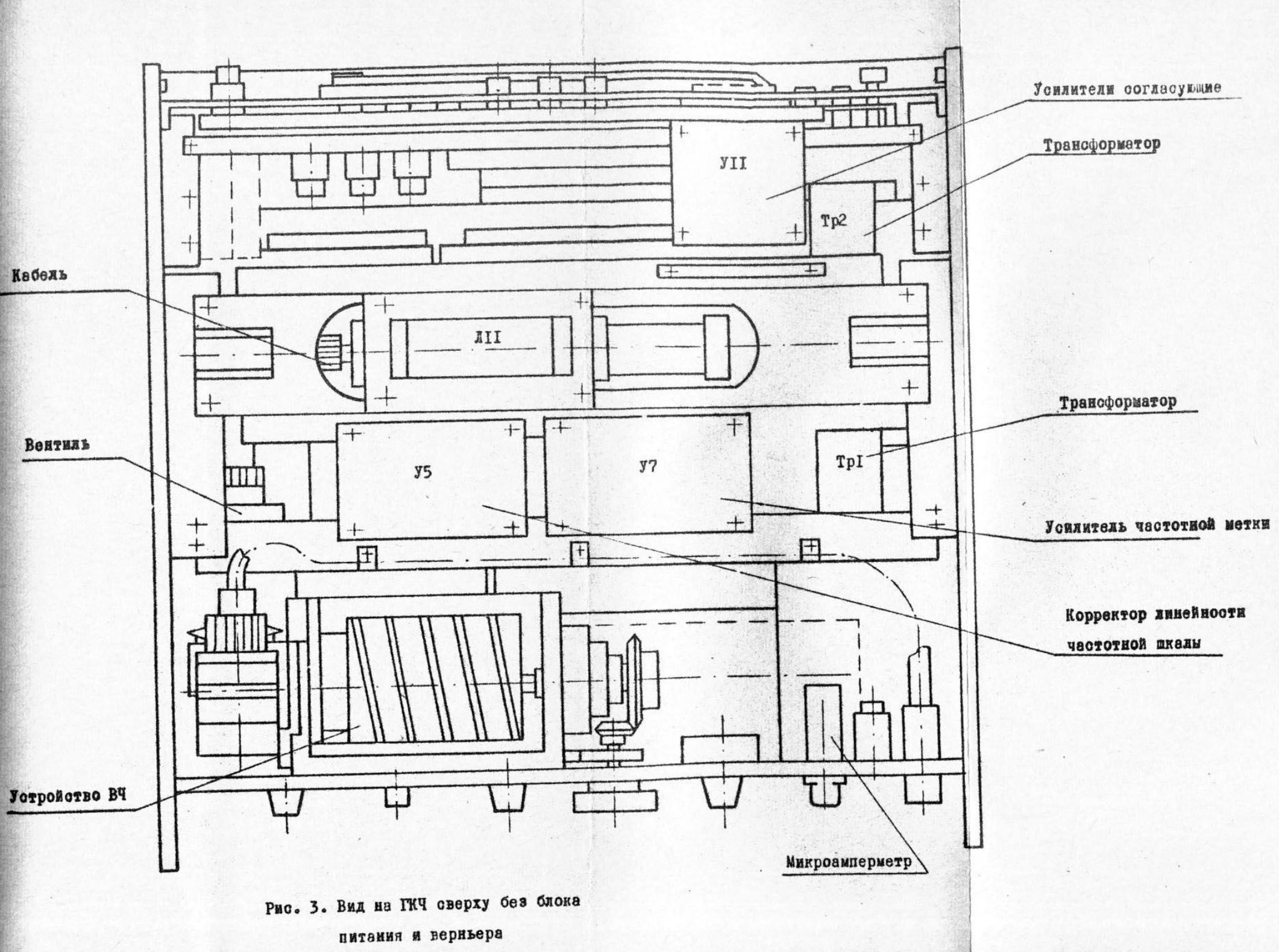
Рис. 3. Вид на ГИК сверху без блока
