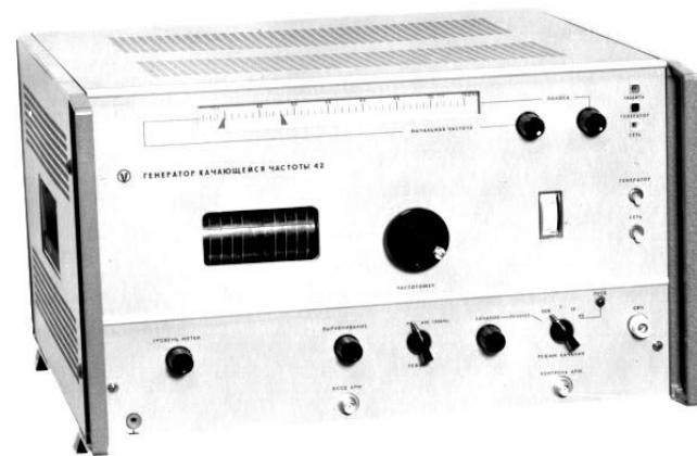
Общий вид генератора качающейся частоты
