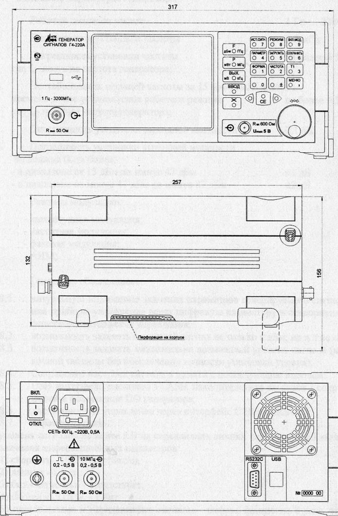
Рис. 1. Общий вид генератора Г4-220А и его габаритные размеры
