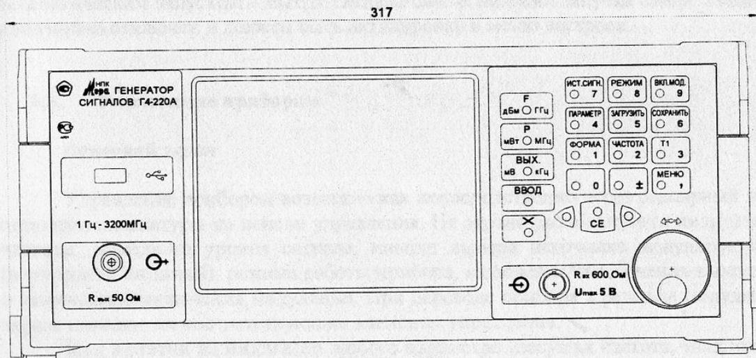
Рис. 2. Общий вид передней панели генератора.
