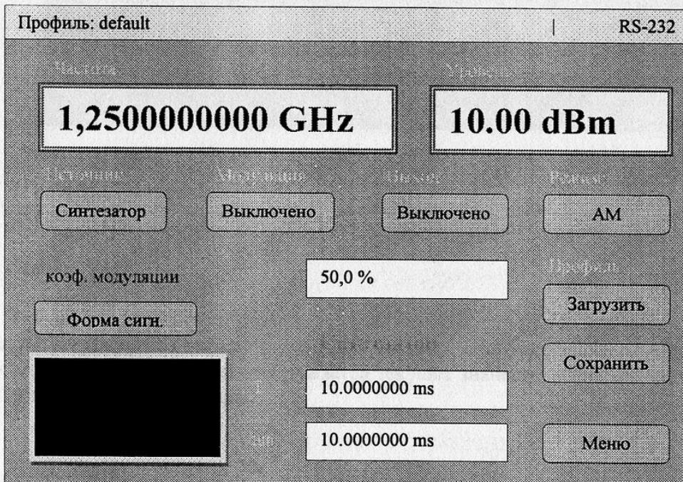
Рис 4. Вид индикатора генератора в режиме амплитудно-модулированных колебаний от внутреннего генератора.
