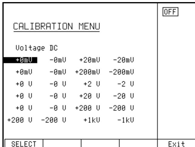
В таблице перечислены рекомендуемые точки калибровки. После того, как будет выбрана необходимая точка калибровки при помощи экранной клавиши SELECT, на экране отображаются следующие данные.
