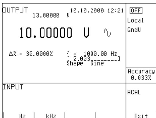
При вводе слишком высокого или слишком низкого значения на экране калибратора отобразится максимально (минимально) допустимое значение для выбранной функции.
