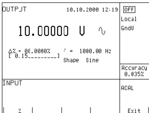
Максимальное значение относительного отклонения, которое можно ввести, равняется  $\pm 30,000\%$ . Отклонение может быть положительным или отрицательным. Если требуется ввести отрицательное отклонение, нажмите экранную клавишу  $+/ -$ . Если требуется ввести положительное отклонение, нажмите экранную кнопку  $+/ -$  повторно. Сменить полярность относительного отклонения можно при помощи клавиш управления курсором или потенциометра.
