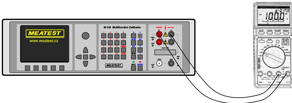
Для испытания мультиметров можно использовать сигнал с ограничением по амплитуде, имеющий заданный коэффициент нелинейных искажений.
