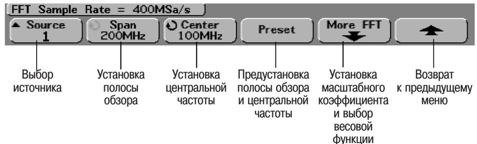
Программируемая клавиша **Source** (источник) задает источник для функции FFT. Источником может быть любой аналоговый канал или математические функции  $1 + 2$ ,  $1 - 2$  или  $1 * 2$ .
