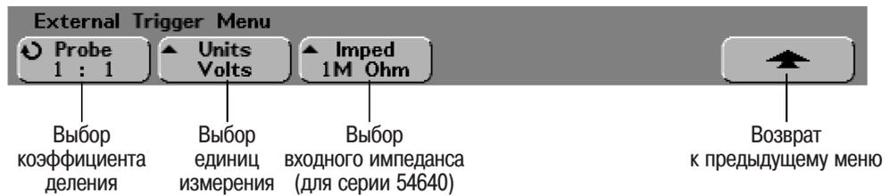
**Probe Attenuation** (коэффициент деления пробника). Вращать ручку Entry, чтобы установить коэффициент деления для подсоединенного пробника. Коэффициент деления отображается в поле программируемой клавиши **Probe**. Коэффициент деления может быть установлен в пределах от 0,1:1 до 1000:1 в соответствии с рядом чисел 1-2-5.
