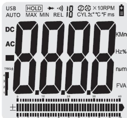
**AC DC** Нажать кнопку MODE и выбрать режим переменного тока (AC) или постоянного тока (DC)
