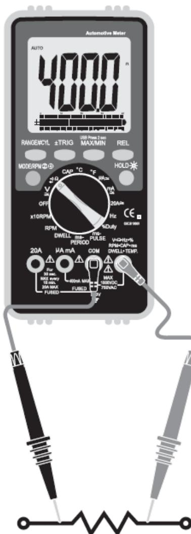
**4-3. Режим измерения – проверка диодов ( ➤ )****ВАЖНО:** выключить напряжение в проверяемой цепи.
