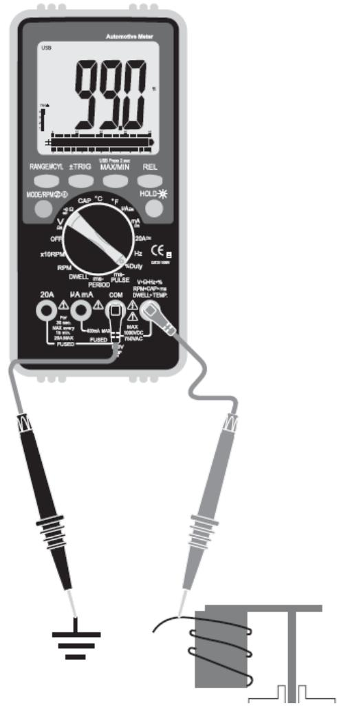
**4-10. Режим измерения – длительность (ms-pulse) и период (ms-period) сигнала**
