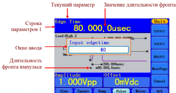
Рисунок 5-9. Установка значения длительности фронта импульса
