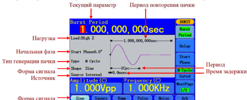
Рисунок 5-20. Интерфейс режима генерации пачки с заданным количеством периодов
