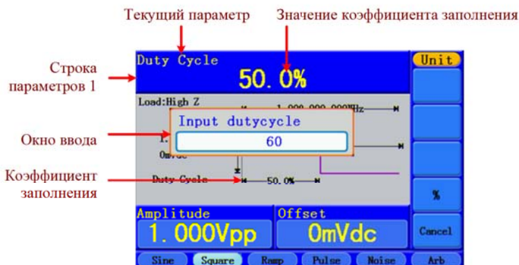
Рисунок 5-4. Установка значения коэффициента заполнения прямоугольного сигнала
