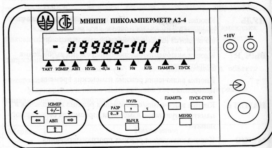
Рисунок 2.2 – Схема расположения органов управления и подключения на передней панели пикоамперметра
