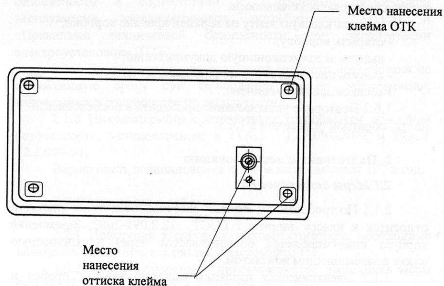
Рисунок 1.3 – Места пломбирования и нанесения клейма поверителя.
