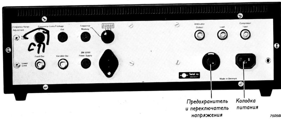
Рис. 2.3 Задняя панель генератора 1023
