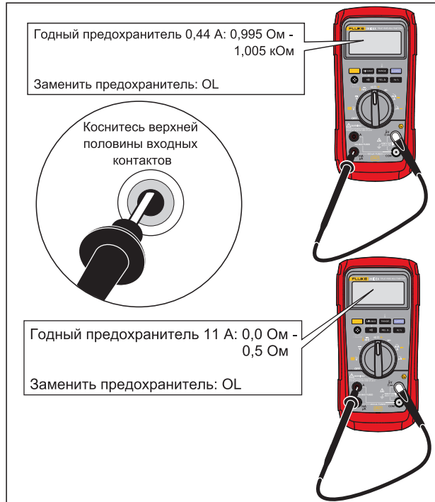
Рис. 10. Проверка предохранителей
